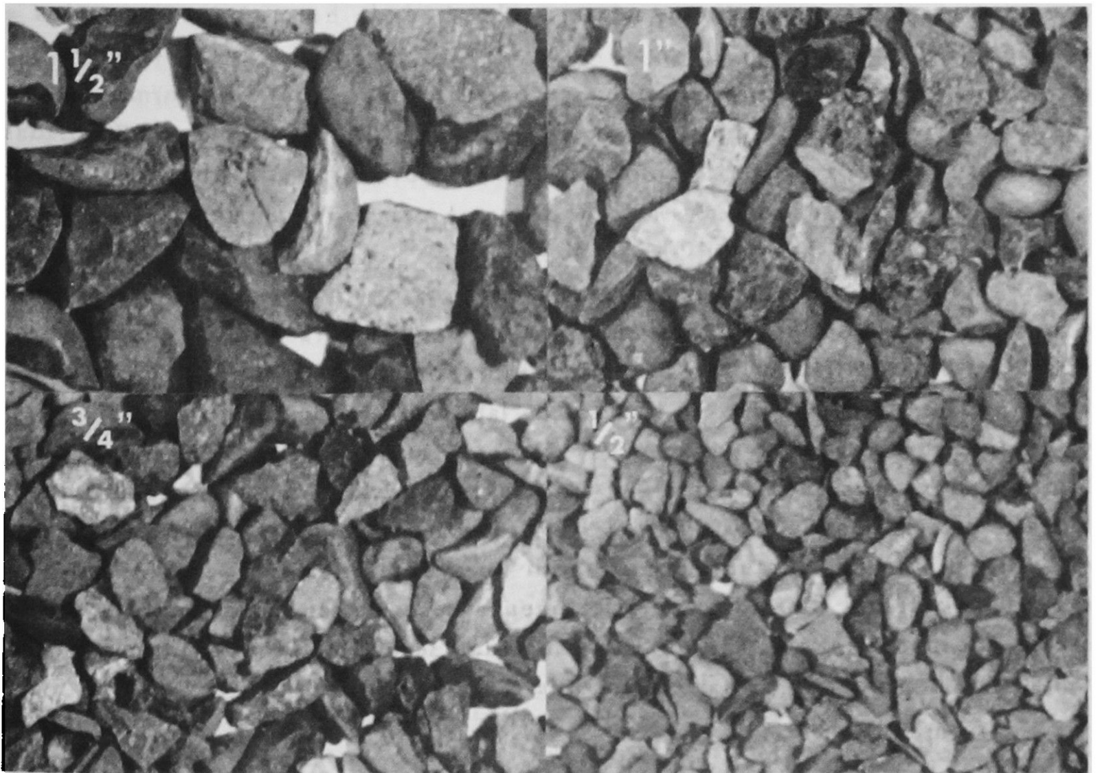
Fig. 2. Arido chancado de forma sub-angular y superficie rugosa.
